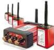
Alava Ingenieros de la mano de su socio tecnológico Wölfel, lanzan el revolucionario sistema inalámbrico RedSens para la medición de vibraciones. RedSens es un novedoso analizador de vibraciones Wi-Fi que permite la sincronización de canales. Representa un sistema completo de medición, análisis y evaluación. Se pueden conectar hasta 10 módulos individuales (nodos) a la vez y cada uno de ellos permite tres entradas de señal o un sensor triaxial ya integrado.
